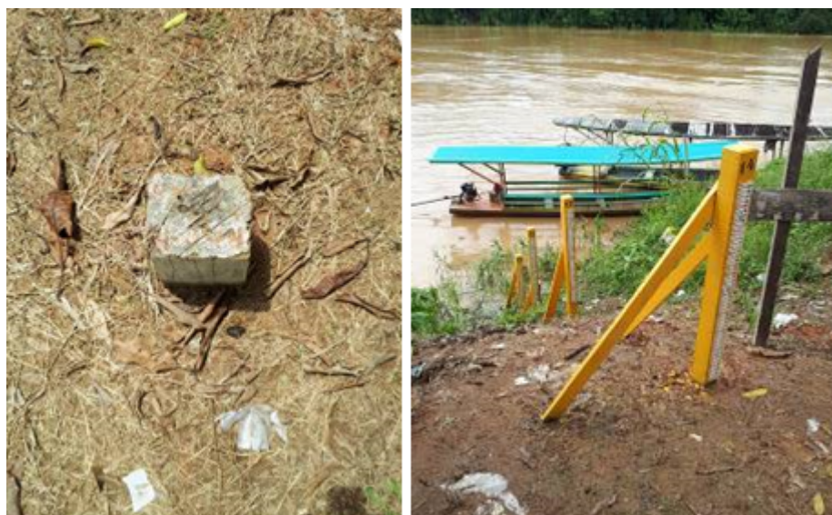
Foto 07: Situação encontrada do RN1. Foto 08: Posto de Réguas instalado.
