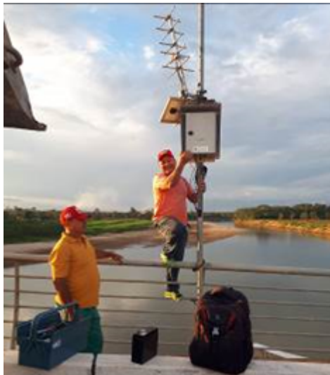
Foto 24: Substituindo a bateria da PCD na Ponte de Tarauacá. Foto 25: Removendo a PCD do Seringal Mucuripe.
