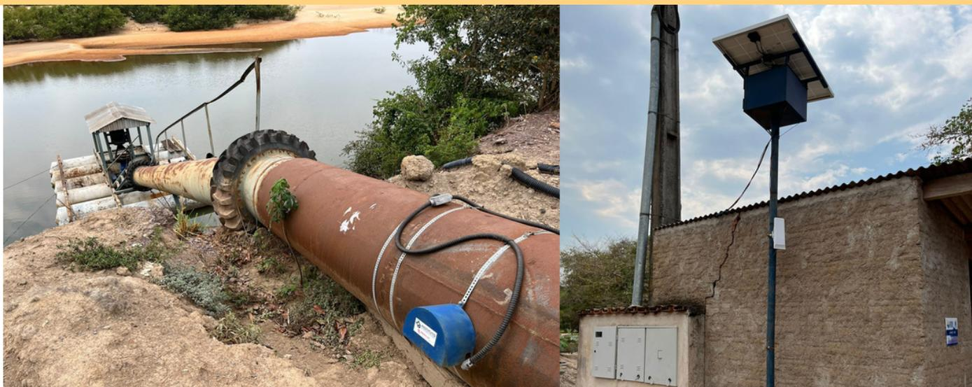
Medidor ultrassônico de vazão acoplado a sistema de transmissão de dados, localizado na bacia do rio Javaés/TO
