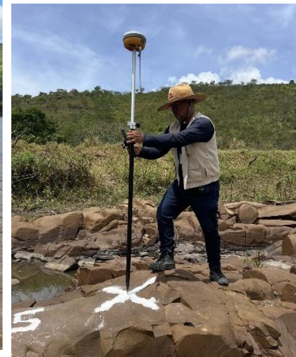
Levantamento batimétrico e implantação de pontos de controle para aerolevantamento por drone. (fonte: SEMAC, 2025).
