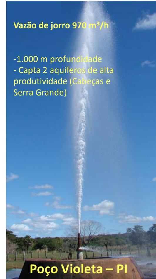
O objetivo do teste de bombeamento (produção) é a determinação da vazão de estabilização e do nível dinâmico correspondente. Não existe teste sem esses dados, portanto não faz sentido o preenchimento apenas parcial desses campos
