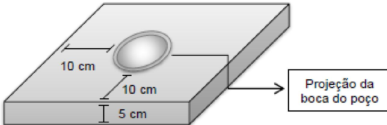
**Figura 1 - Desenho esquemático da laje de proteção sanitária do poço.**
