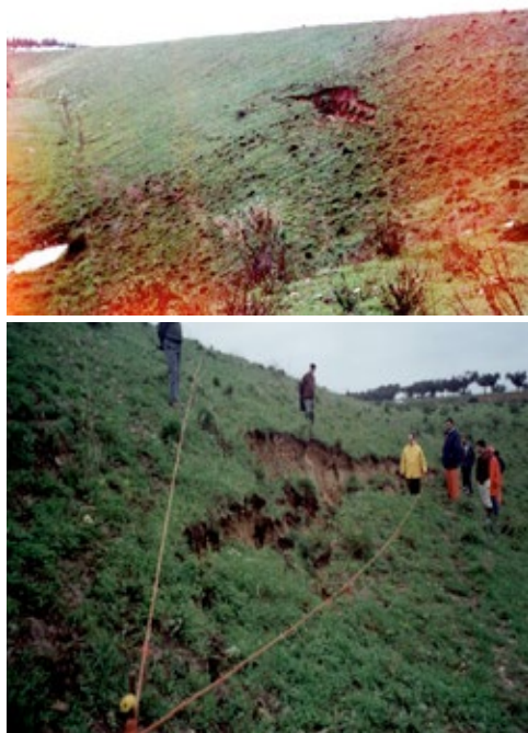
Figura 16 – Deslizamento profundo com formação de escarpa
