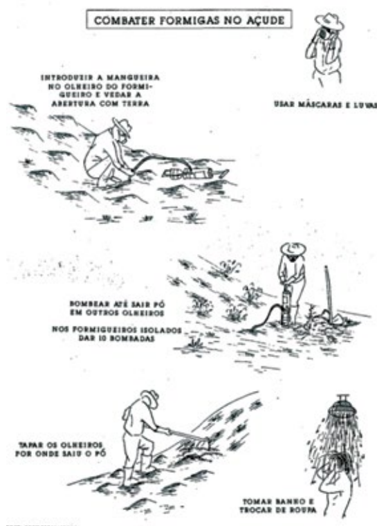
Figura 28 – Tratamento de zona afetada por formigueiro (Molle e Cadier, 1992)
