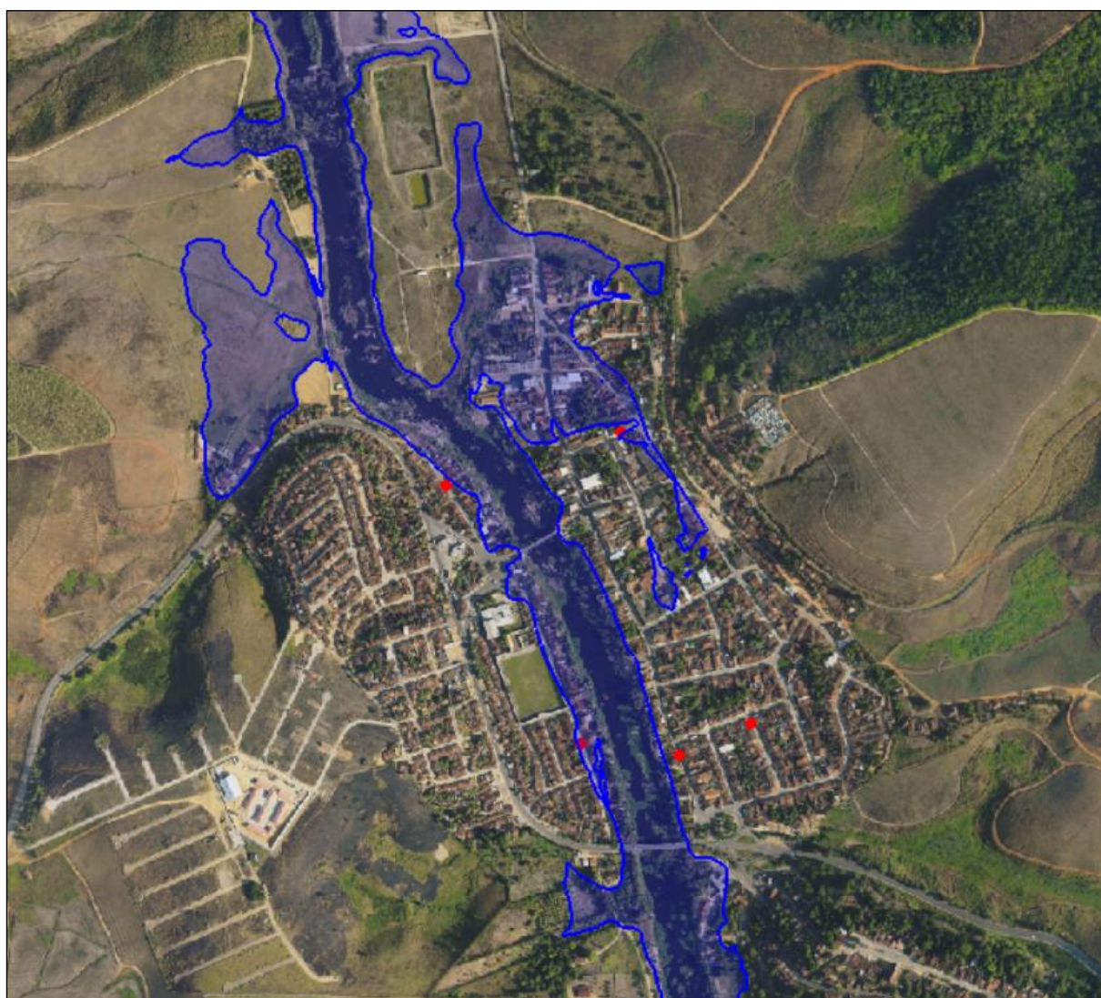
Figura 33. Contorno da mancha máxima de inundação do evento de 2010 obtida para Atalaia através das simulações com HEC-RAS e pontos de inundação levantados.
