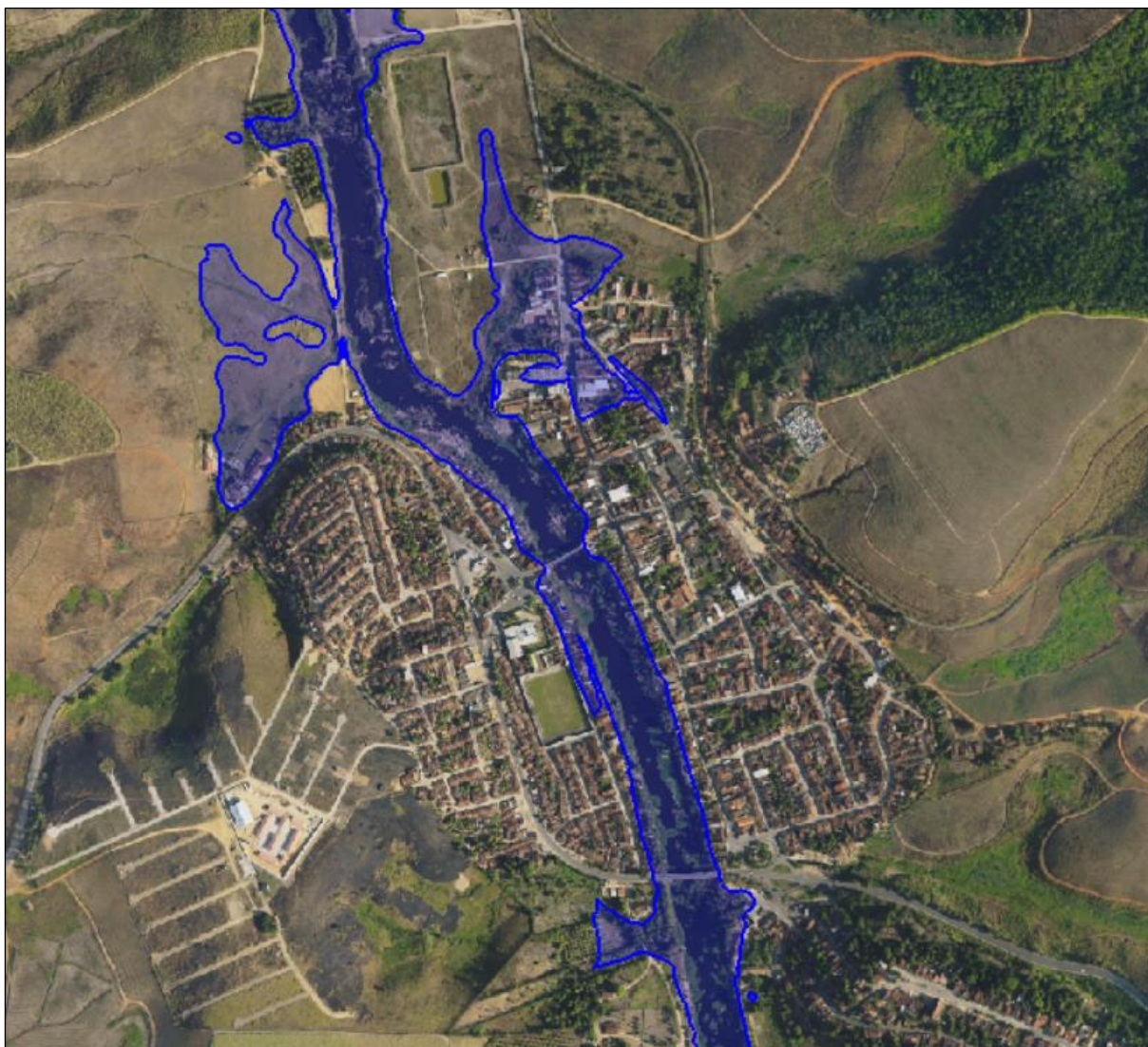
Figura 34. Contorno da mancha máxima de inundação do evento de 2017 obtida para Atalaia através das simulações com HEC-RAS
