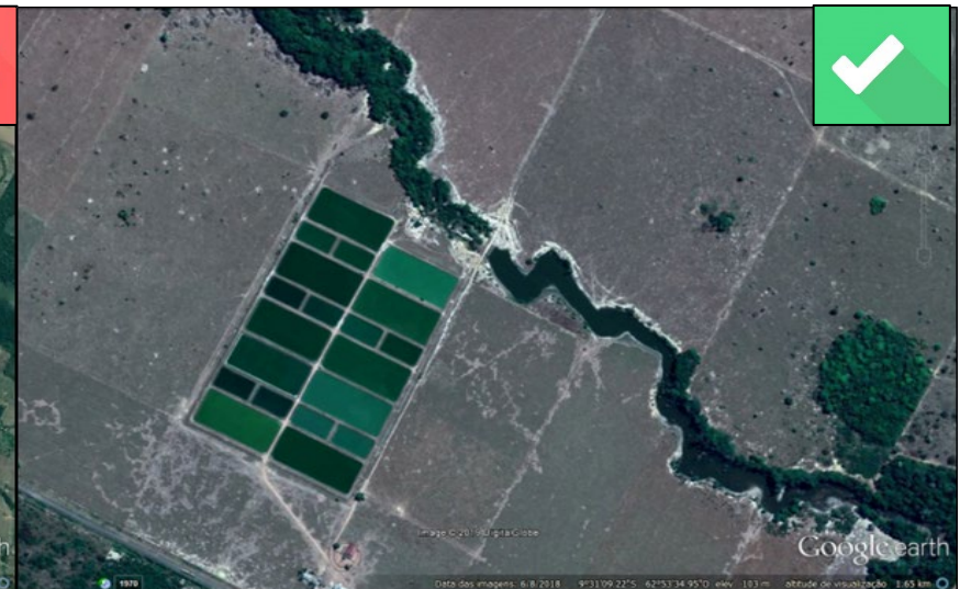
Tanque escavado fora de leito de rio
