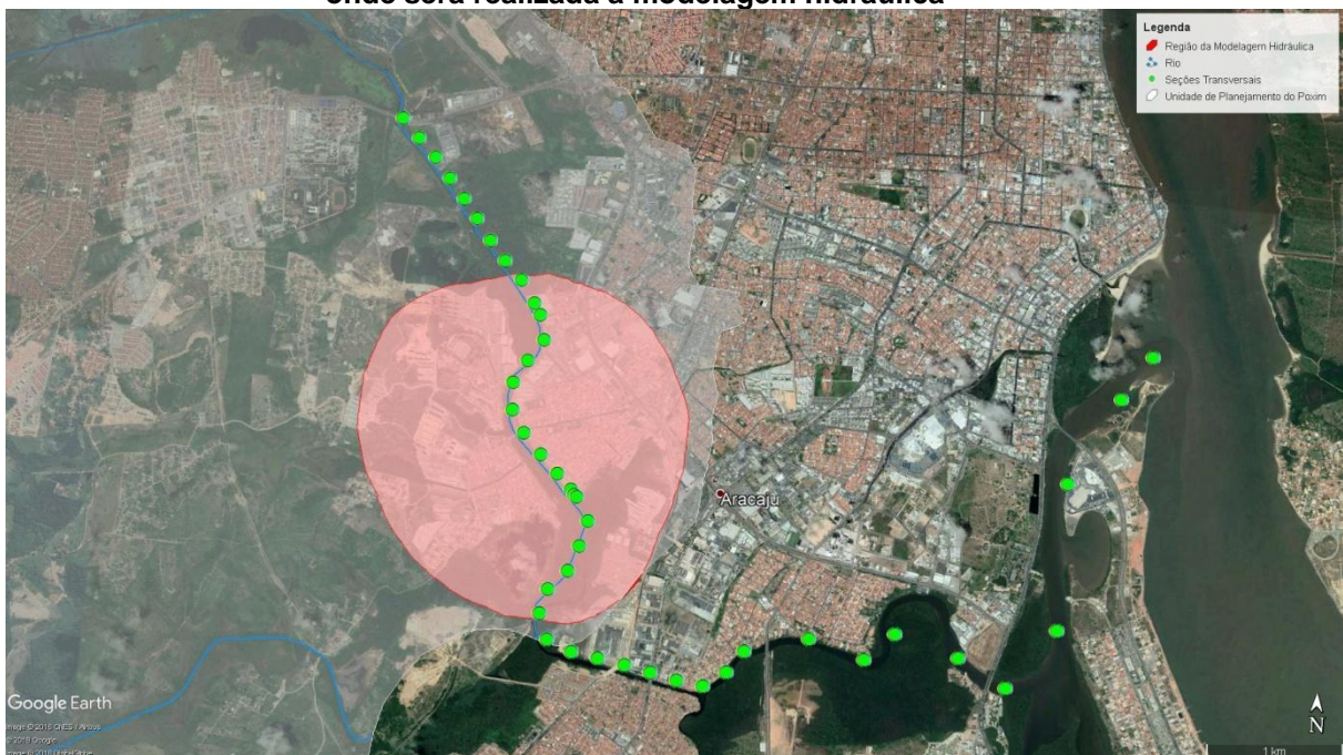
Figura 3 - Seções transversais levantadas pela DESO/SEMARH. Em vermelho a região onde será realizada a modelagem hidráulica
