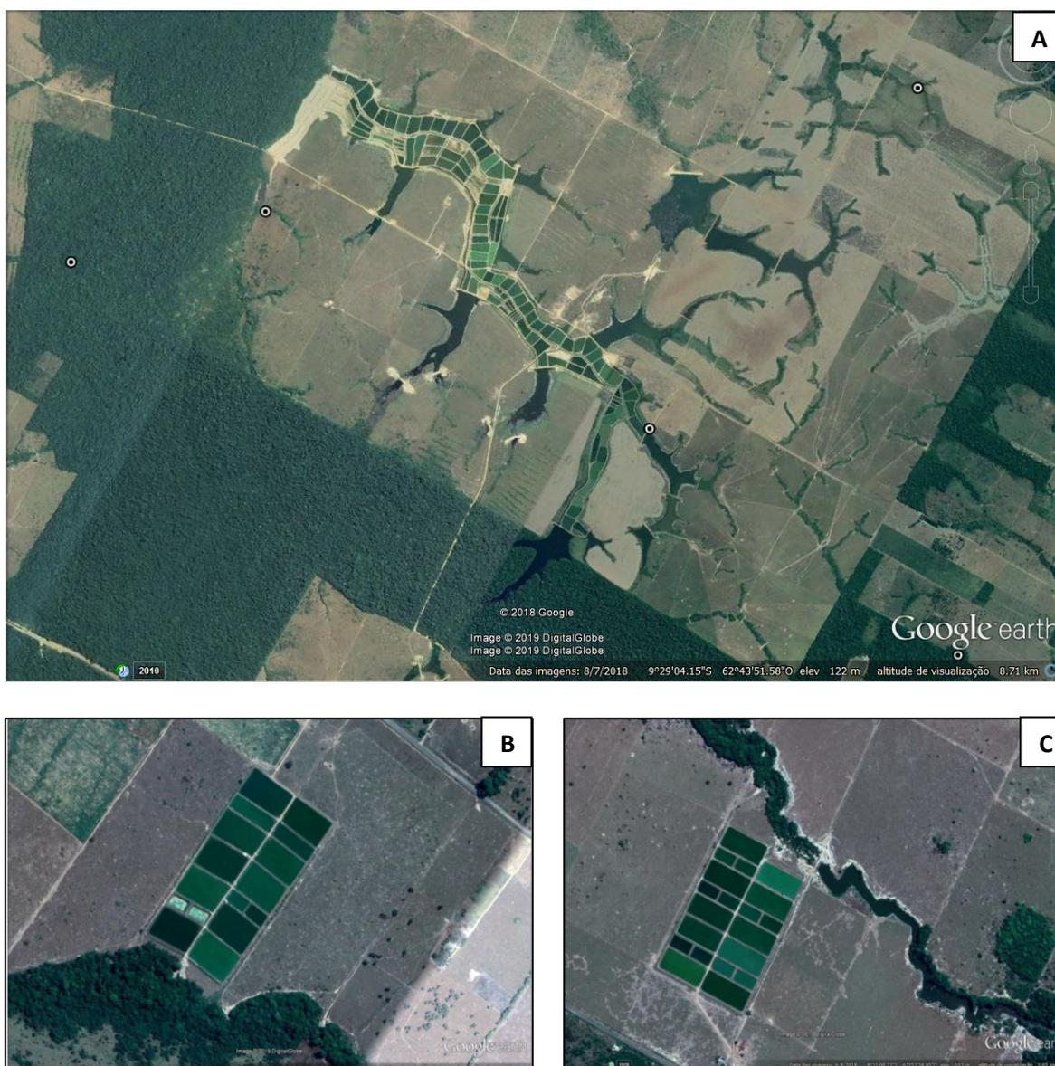
Figura 6. A) Tanques de piscicultura escavado em leito de rio; B) Tanque escavado fora do leito do rio com captação no mesmo; C) Tanque escavado fora do leito do rio com captação em reservatório de barramento de rio.
