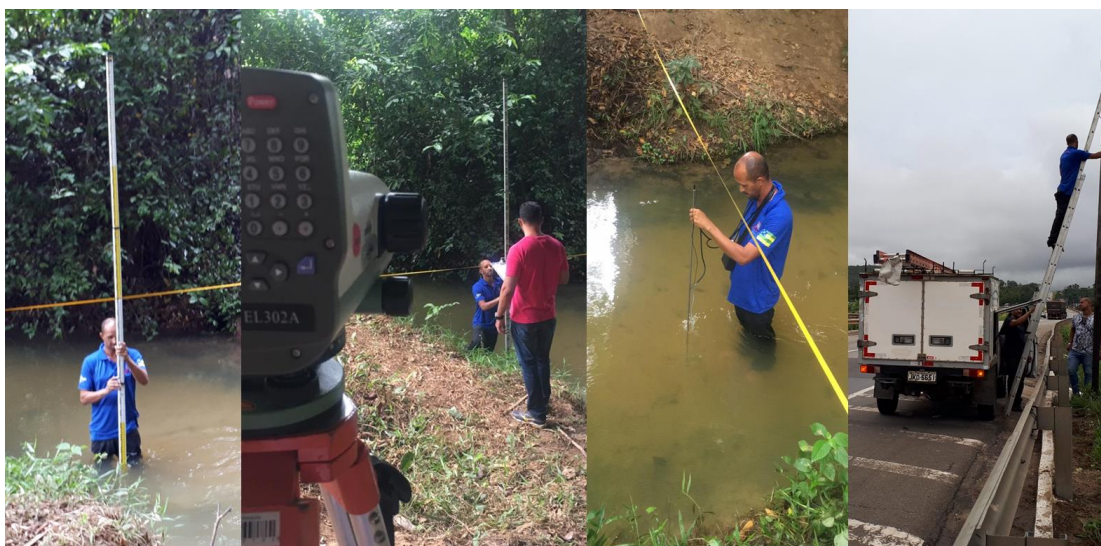
Figura 31. Levantamento da seção e medição de vazão na estação BR-101 (14/03/2019).
