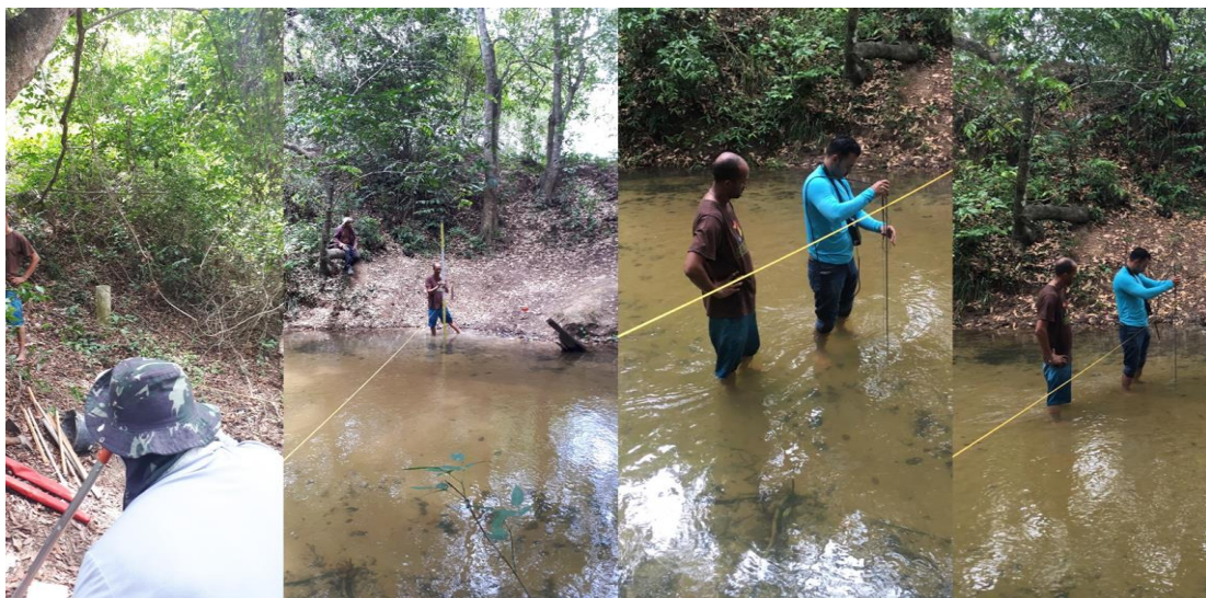
Figura 31. Levantamento da seção e medição de vazão na estação BR-101 (14/03/2019).
