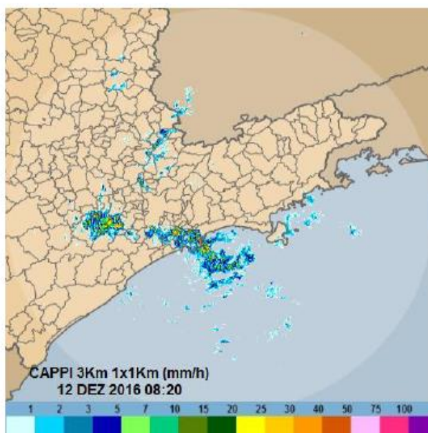
Radar DAEE - Precipitação Instantânea (mm/h) Produzido pelo Radar 600S-Selex, Banda S, 850 KW, Doppler, Dupla Polarização.
