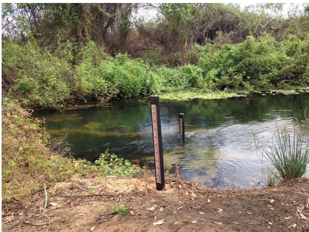
*Figure 29 – Localização das réguas limnimétricas em uma das seções monitoradas do rio Jaguaribe.*
