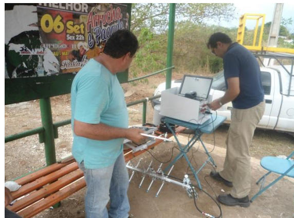
Fig. 74 – Montagem da antena e da PCD.
