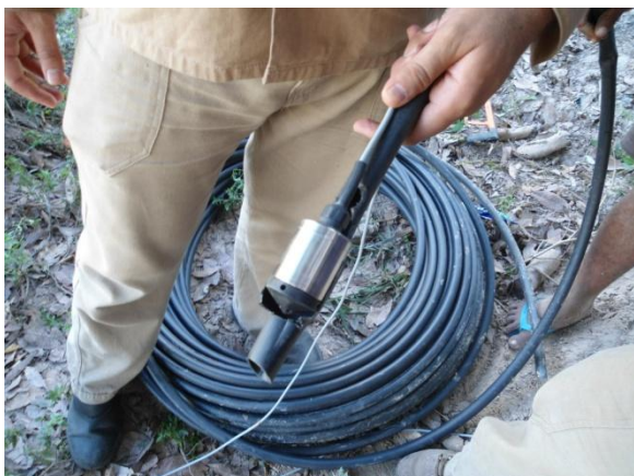
Fig 5 - Instalação do Medidor de Pressão
