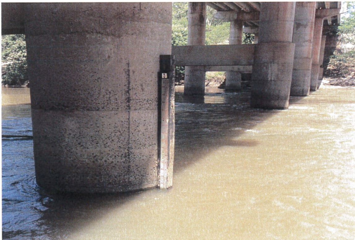
Figura 4 – Leitura da régua linimétrica da estação fluviométrica de Palmeiras – Rio Aquidauana.
