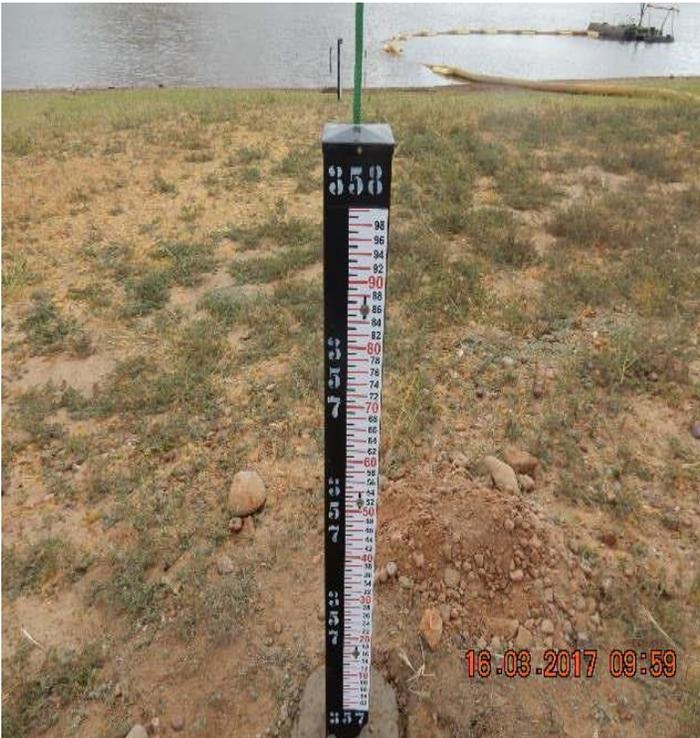
Seção de régua Açude Ponto Novo - BA
