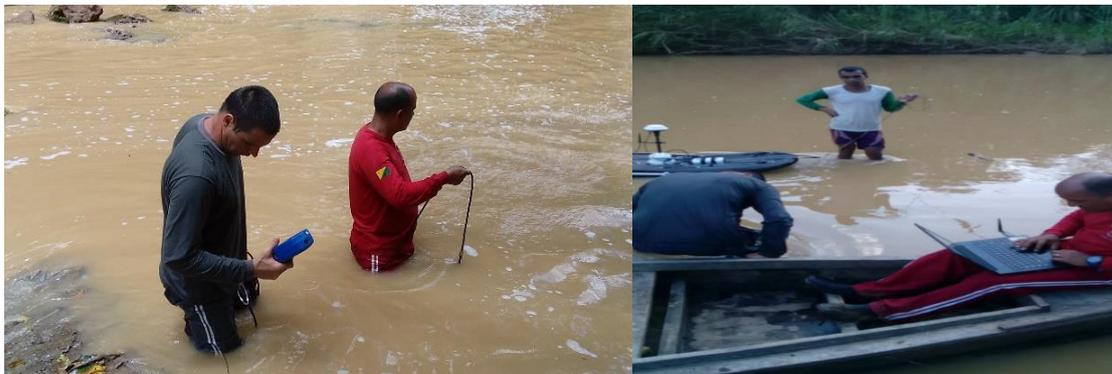
Medição da qualidade da água com sonda multiparamétrica
