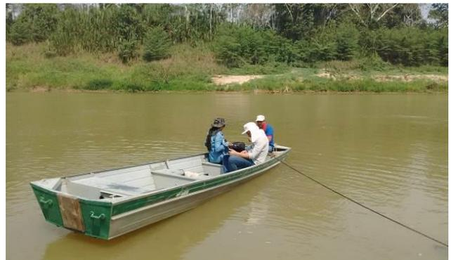
*Figura 36 - Medição de vazão – Porto Acre*
