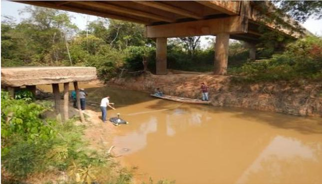
*Figura 33 - Medição de vazão - Iquiri*
