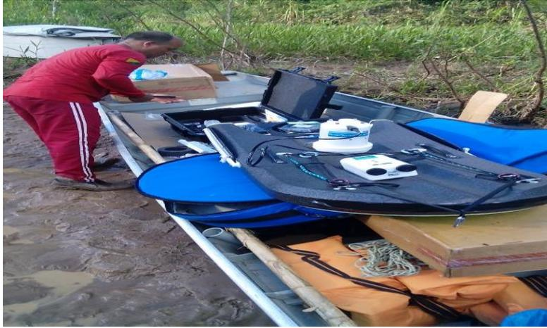
Medição de vazão utilizando o equipamento M9
