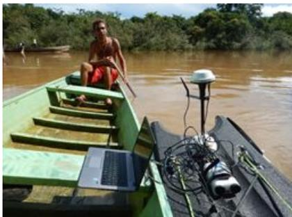
**Figura 44** – Rio Abunã em Plácido de Castro - Medição de Vazão com ADCP/M9 e Medição da Qualidade da Água com sonda KOR/EXO
