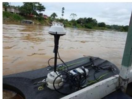
**Figura 49** – Rio Acre em Boca do Acre - Medição de Vazão com ADCP/M9 e Medição da Qualidade da Água com sonda KOR/EXO
