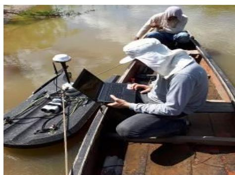
**Figura 79** – Medição de vazão - Brasileia
