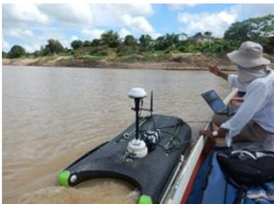
**Figura 63** – Rio Iaco em Sena Madureira - Medição de Qualidade da Água e Medição de Vazão
