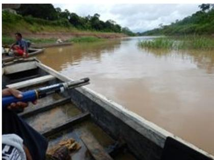
**Figura 46** – Rio Acre em Assis Brasil - Medição de Vazão com ADCP/M9 e Medição da Qualidade da Água com sonda KOR/EXO
