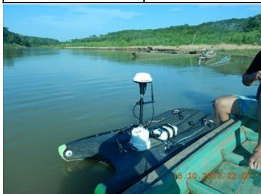
**Figura 96** – Rio Acre em Assis Brasil - Medição de Qualidade da Água e Medição de Vazão
