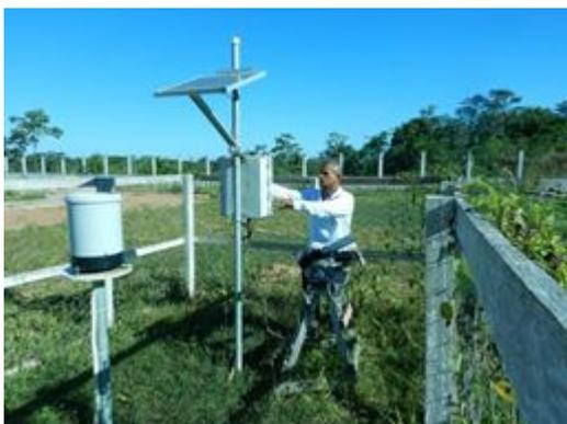
**Figura 85** – Manutenção da PCD do IFAC em Tarauacá
