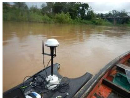
**Figura 47** – Rio Acre em Brasília - Medição de Vazão com ADCP/M9 e Medição da Qualidade da Água com sonda KOR/EXO
