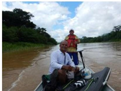
**Figura 45** – Rio Acre em Rio Branco - Medição de Vazão com ADCP/M9 e Medição da Qualidade da Água com sonda KOR/EXO
