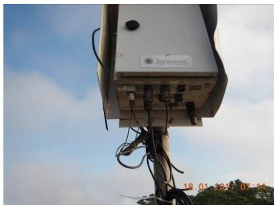
**Figura 39** – PCD da Ponte do Rio Liberdade com os cabos cortados
