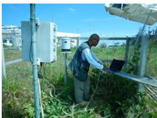
**Figura 88** – Manutenção na PCD do IFAC em Cruzeiro do Sul
