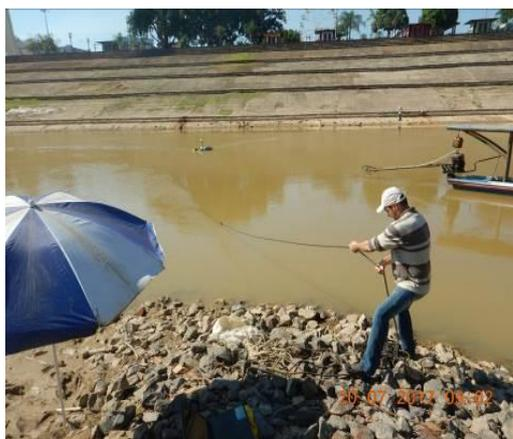
**Figura 82** – Medição de vazão em Rio Branco.
