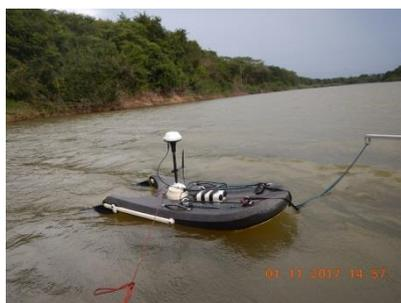
Medição de vazão/ M9 do QUALIÁGUA
