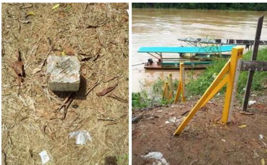
Fotos 7 e 8: Situação encontrada do RN1 e Posto de Régua instalado.
