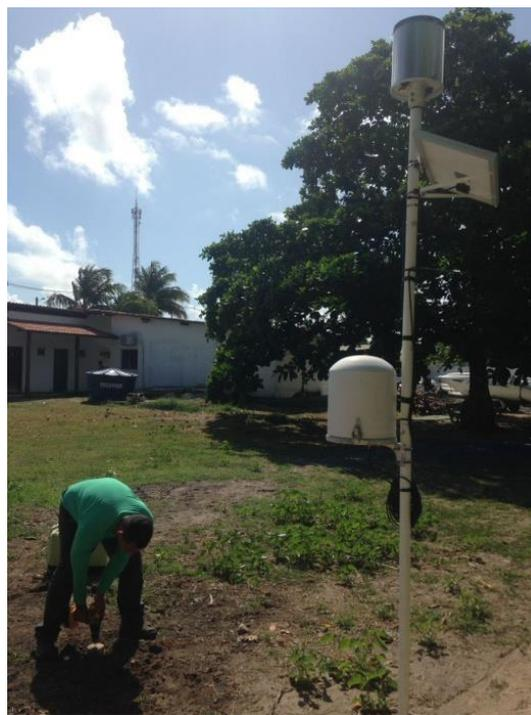
Após essa etapa, iniciou-se a atividade de campo para a determinação da altitude ortométrica do RN criado junto da estação automática, executando o nivelamento e o contranivelamento para conferência dos resultados obtidos no procedimento utilizando o GPS geodésico adquirido pela SEMARH (**Figura 4.20**).
