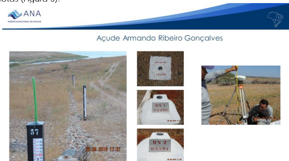
Figura 2 – Padrão definido pela ANA para instalação das Seções de Réguas e RNs
