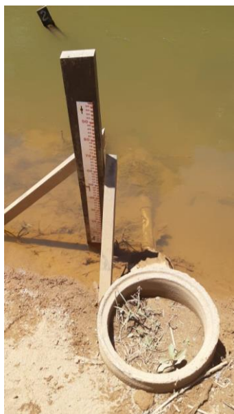
Foto 04 - Caixa de passagem sensor de nível obstruída por sedimentos.
