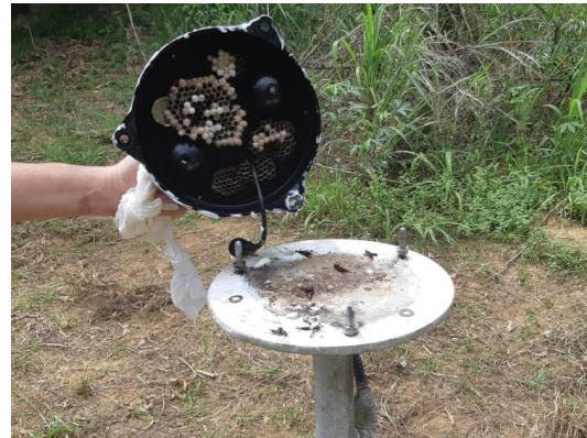
Foto 03 – Limpeza do pluviômetro.
