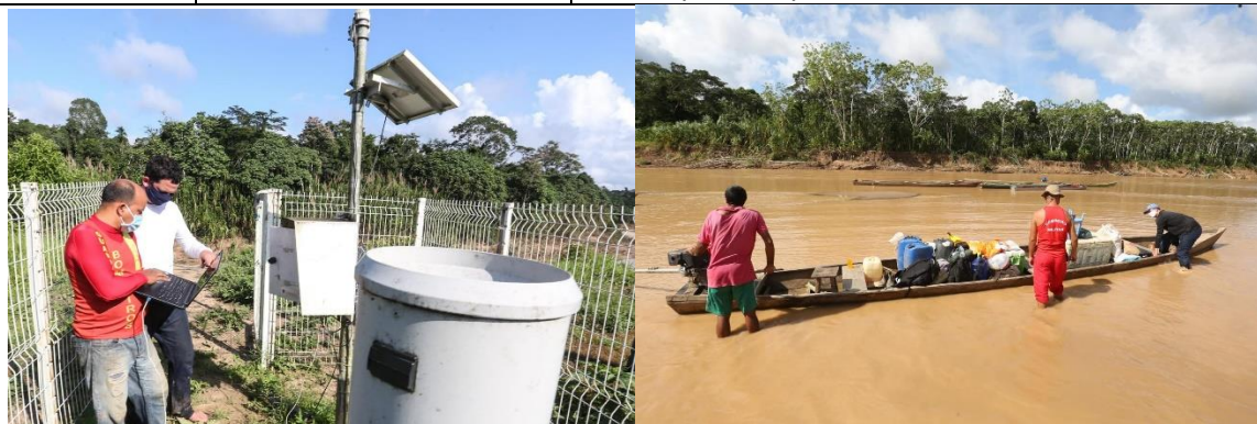
Foto 3: Manutenção corretiva da Plataforma de Coleta de Dados na Aldeia Lago dos Patos, município de Assis Brasil - AC.
