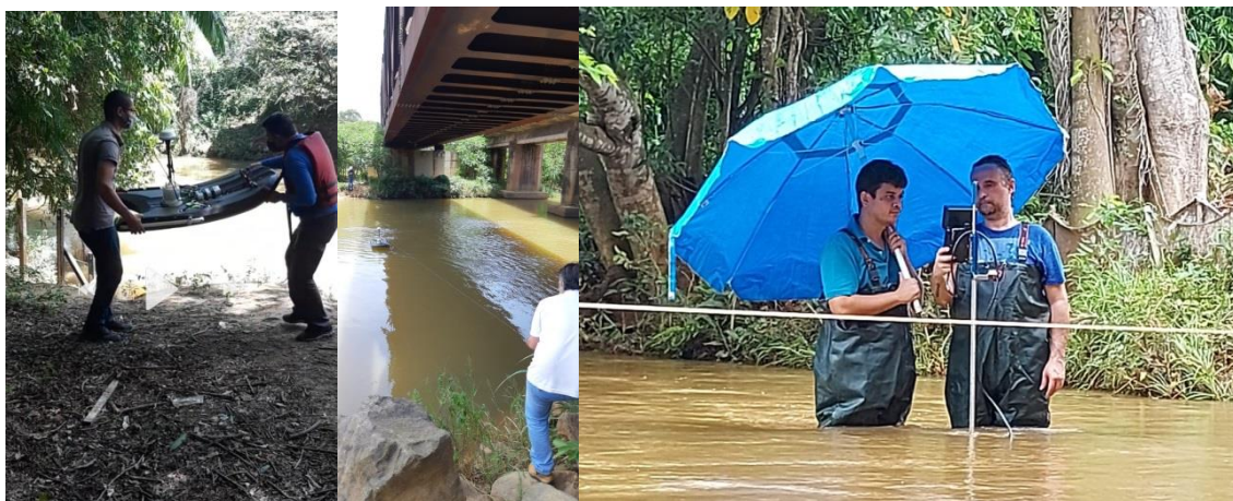
Figura 4.10 - Medição de vazão com perfilador acústico (M9 e Flowtracker)
