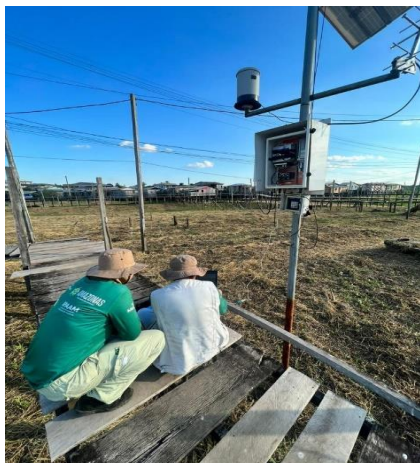
FIGURA 3: MANUTENÇÃO NA PCD DE LÁBREA
