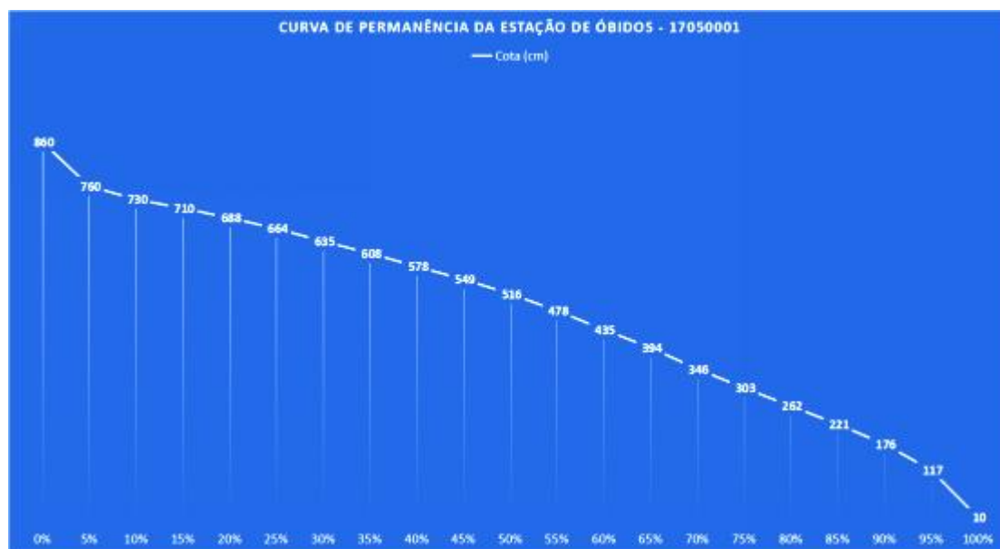
Figura 1.4.6. Exemplo da curva de permanência da estação hidrológica do rio Amazonas em Óbidos.
