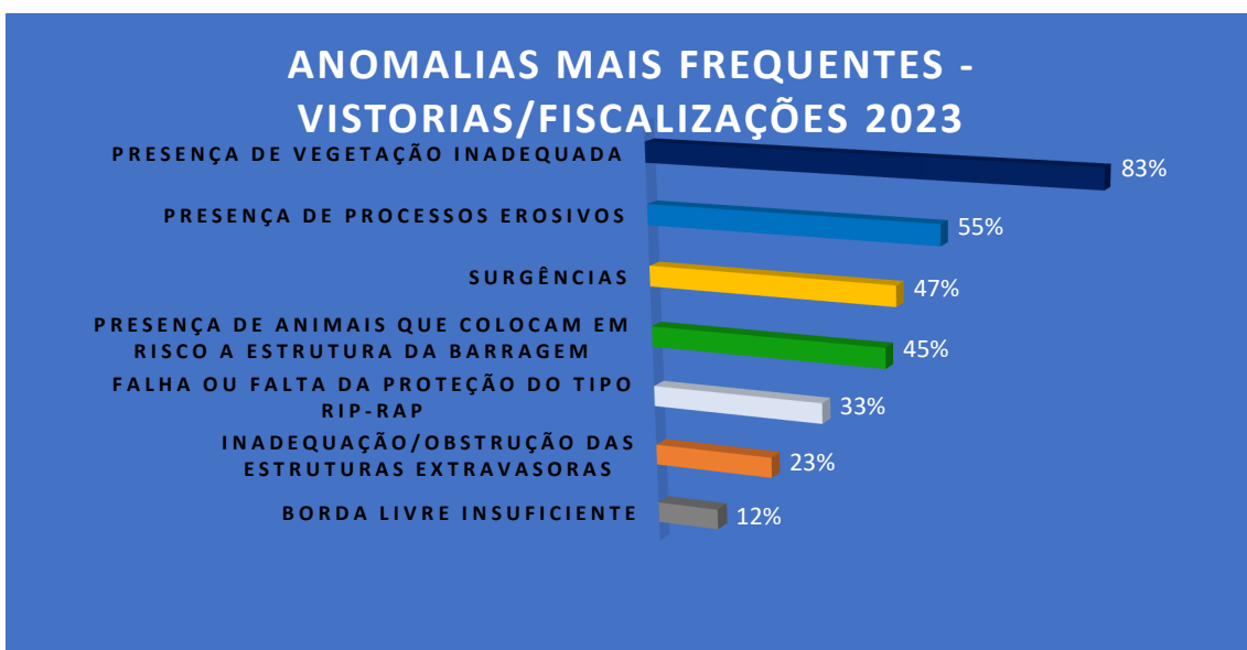
Figura 6 - Resumo das principais anomalias encontradas nas vistorias de barragens – 2023
